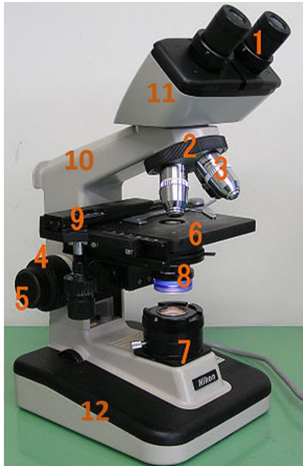
Legenda: 1 - lente ocular; 2 - revólver ou porta objetivas; 3 - objetivas; 4 - parafuso macrométrico; 5 - parafuso micrométrico; 6 - mesa ou platina; 7 - fonte de luz; 8 - diafragma; 9 - charriot; 10 - coluna ou braço; 11 - tubo ou canhão; 12 - pé ou base.
